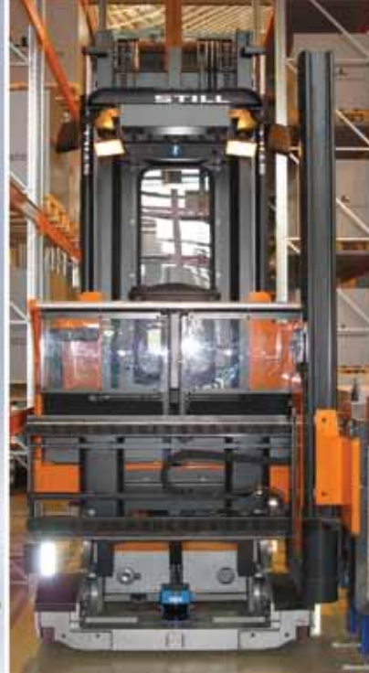
Pilt 10.28 Poolautomaatne kombitõstuk
