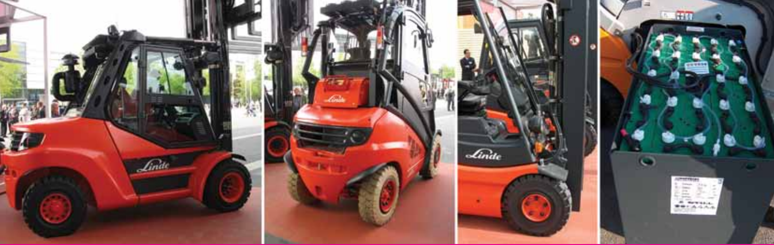
Pilt 10.1 Diiselmootoriga vastukaaltõstuk
