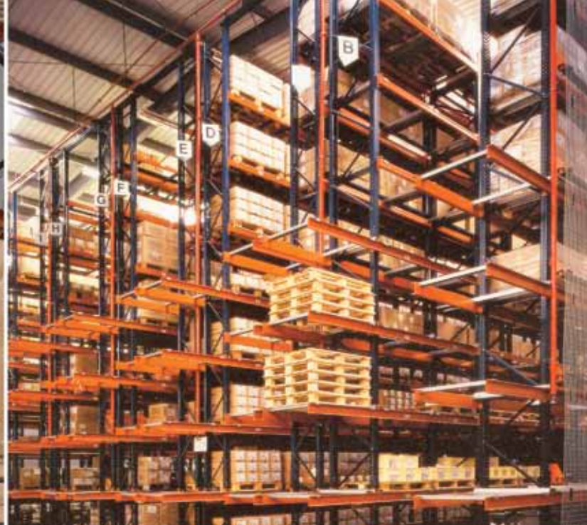
Pilt 10.22 Süstiktõstuki terminalikohad riulite otstes
