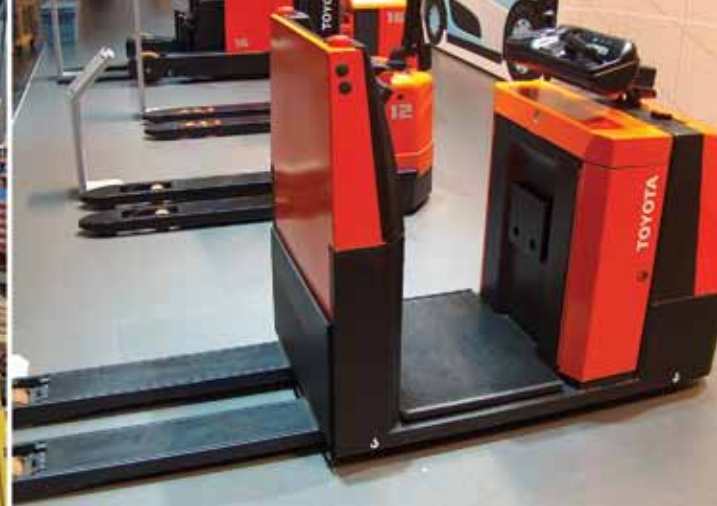
Pilt 10.18 Tõstetava juhikohaga madalkomplekteerimistõstuk
