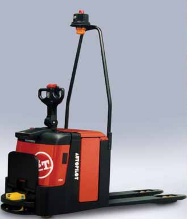
Pilt 10.27 Poolautomaatne siirdetõstuk
