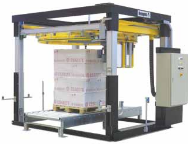
Pilt 10.31 Kaubaaluse mähkimine pakkelilega täisautomaatse pakkimismasinaga
