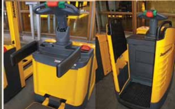
Pilt 10.12 Juhiplatvormiga siirdetõstukid
