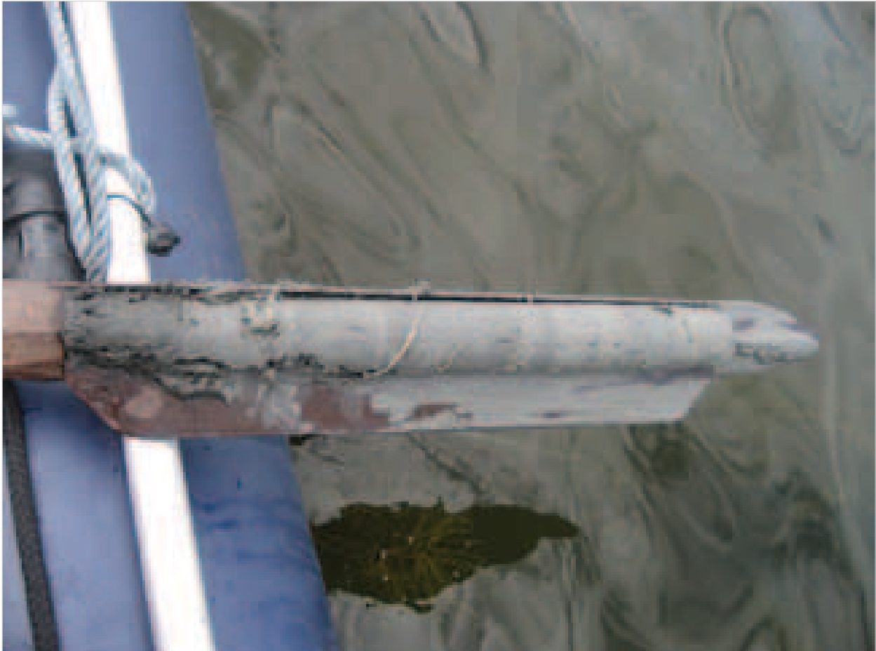
Foto 4.2.7.1. Settepuursüdamik Vööla merest. Turbapuuri kannus näha olev settepuursüdamik on 50 cm pikk. Pinnal tumehall muda, järgneb aleuriit, mis puursüdamiku alumises osas läheb üle aleuriitsaviks. (Foto A. Kisand)
