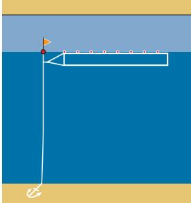
**es** Red de enmalle de deriva **cs** Unášená plovoucí síť **da** Drivgarn **de** Treibnetz **et** Ajuvőrk **el** Παρασυρόμενα απλάδια **en** Driftnet **fr** Filet dérivant **it** Rete da posta derivante **lv** Driftteriklis **lt** Dreifinis tinklas **hu** Driftnet **mt** Xibka kbira li fiha jidhol il-hit mal-kurrent tal-bahar **nl** Drijfnet **pl** Pławnica **pt** Rede de emalhar de deriva **sk** Nástražná siet **sl** Viseča ribiška mreža **fi** Ajoverkko **sv** Drivgarn
