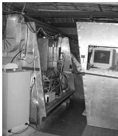
Joonis 4. Boks aparatuuriga, vasakul selle ees aerosoolispektromeeter EAS.
