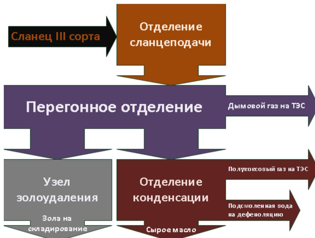
Рис.5.30. Блок-схема установки ENEFIT-140
