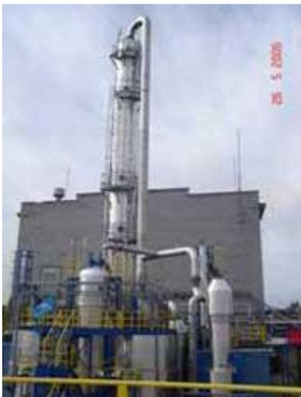
Рис.7.10. Установка производства формалина путем окисления метанола с использованием серебряного катализатора
