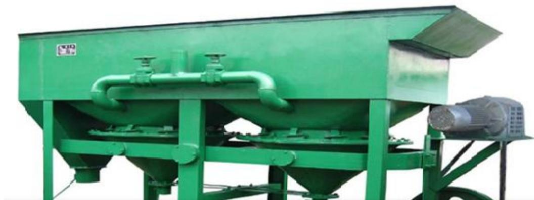
Рис. 2.9. Машина для гравитационного обогащения полезных ископаемых
