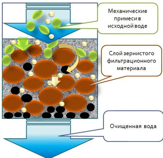
Рис.4.12. Фильтр в режиме фильтрации
