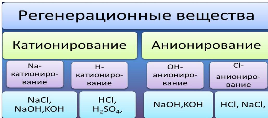
Рис.4.19. Регенерация ионитов.
