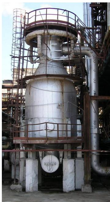
Рис.6.7. Шахтный конвертор метана:
