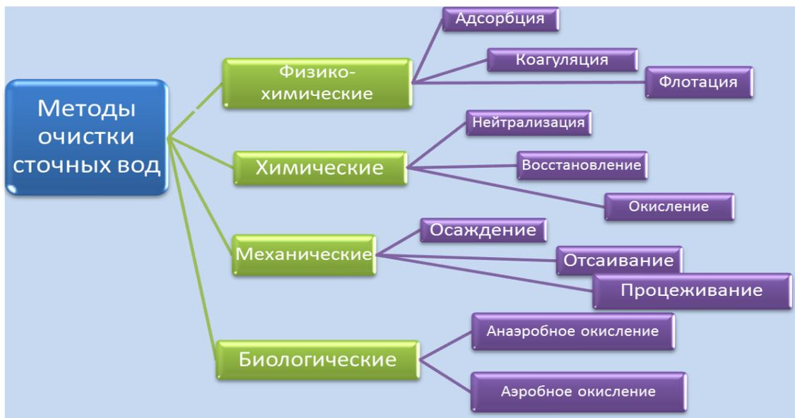
Рисунок 4.25. Классификация методов очистки сточных вод
