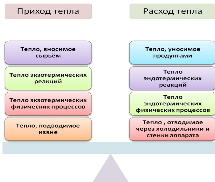
Рис. 3.37. Схема теплового баланса
