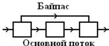
Рис. 3.34. Обводное или байпасное соединение аппаратов
