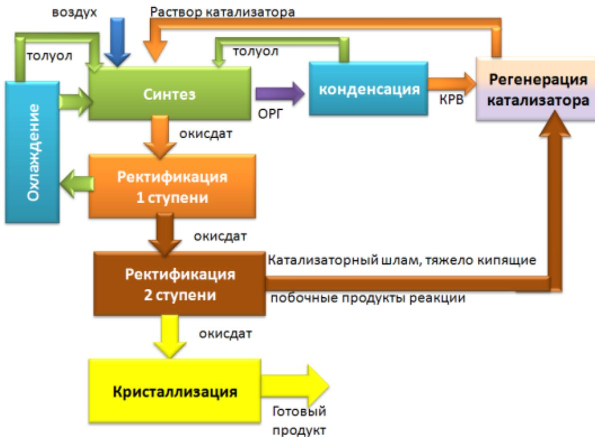
Рис.7.2 Блок схема производства бензойной кислоты
