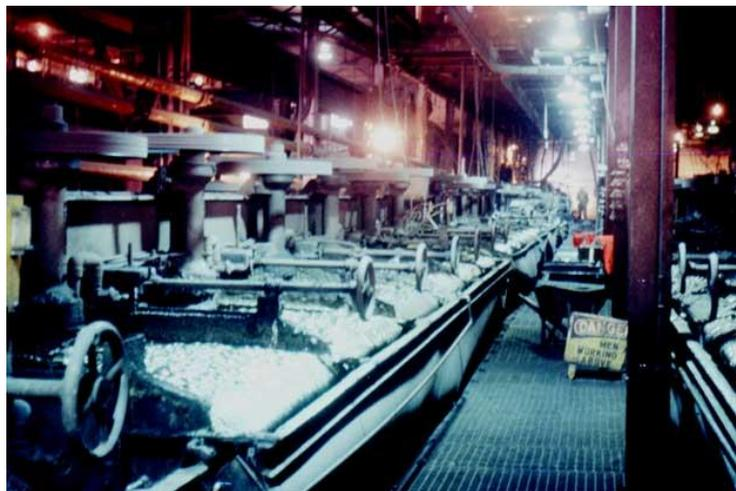
Рис. 2.17. Цех флотации
