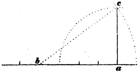
Wenn aber der rechte Winkel auf dem freien Felde, wo keine Kreisdurchschnitte gemacht werden können, errichtet werden soll, so misst man auf der Grundlinie ein beliebiges Stück  $ab$  aus, steckt eine zweite Linie  $bd$  nach beliebiger Richtung ab, macht mit der Kette oder Schnur  $bd = ab$ , steckt die Linie  $ad$  ab, und misst sie aus. Den Unterschied der gemessenen Linien  $ad - ab$  oder
