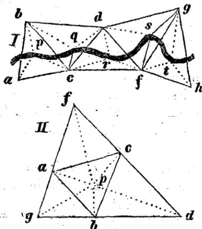
sichtbaren Signalen die Winkel, z. B. in  $p$  die Positionswinkel  $apb$ ,  $bpc$ ,  $cpa$  u. s. w. Hieraus berechnet man die Entfernungen  $pa$ ,  $pb$ ,  $pc$ , und die Lage des Puncts  $p$  in dem Dreieck  $abc$  u. s. w. Auf diese Weise machte ich im J. 1809 eine Vermessung des Embachflusses bei Dorpat, von seinem Ausflusse aus dem Würzsee, bis zu seiner Einmündung in den Peipussee, auf einer Strecke von beiläufig 12 Meilen, mit Hülfe des Spiegelsextanten.
