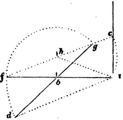
$ad - bd$  trägt man mit der Kette oder Schnur nach  $bf$  und  $bg$ , und steckt die Linie  $fg$  ab, worauf man  $fh = ab$  aufträgt. Da  $af = ad$ ,  $fh = ab$ , und  $\angle hfa = bad$ , so ist (I. 1.)  $\triangle afh = dab$ , also  $ah = bd$ , also  $ah = fh$ . Man trägt also  $fh$  auf  $hc$ , so ist (III. 35.)  $\angle cab = R$ .
