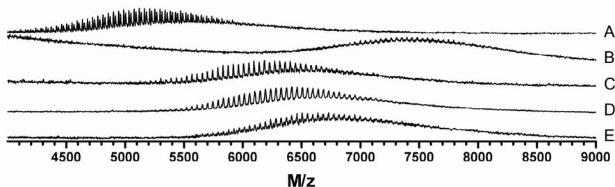
**Figure 8.** The MALDI-TOF MS (matrix DHB) of **A:**  $\text{NH}_2$ -PEG5000-OMe, **B:** Adc(Ip)-Ahx-[L-Arg(Pbf)]<sub>4</sub>-L-Lys(Boc)-NH-PEG5000-OMe, **C:** Adc-Ahx-(L-Arg)<sub>4</sub>-L-Lys-NH-PEG5000-OMe (ARC-701), **D:** Adc-Ahx-(L-Arg)<sub>4</sub>-L-Lys(biotin)-NH-PEG5000-OMe (ARC-703) and **E:** Adc-Ahx-(L-Arg)<sub>4</sub>-L-Lys(BODIPY FL)-NH-PEG5000-OMe (ARC-702).
