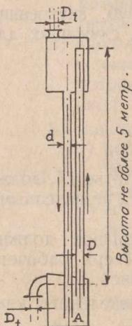
Котлы низкого давления разрешается вместо предохранительного клапана снабжать и вертикальным трубчатым прибором, изображенном на рядом стоящем рисунке, который не допускает повышения давления пара сверх допускаемого рабочего давления, если размеры этого прибора подобраны соответственно последующим размерам.
