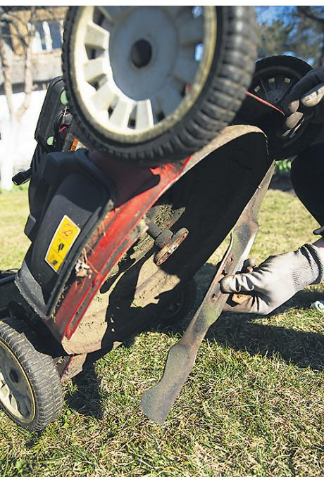
**TERA eemaldamisel on mõistik teha enne terale märge, et hiljem tera õigetpidi alla tagasi saaks. Enne tera eemaldamist tuleks süüteküünlast eemaldada küünla piip.**
