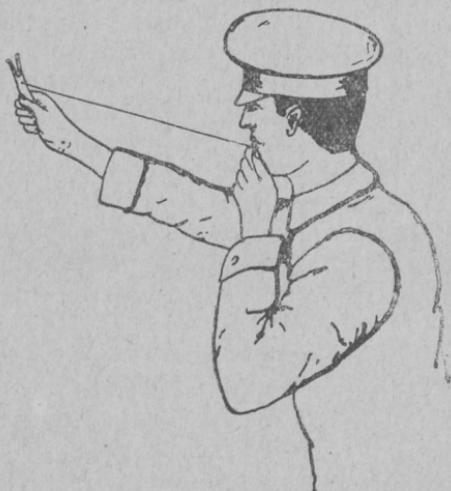
Рис. 49. Применение „Стадии-лиры“ для определения расстояний.
