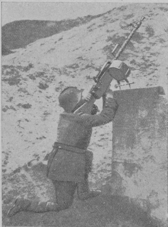
Рис. 18. Немецкое приспособление к пулемету Максима образца 1918 г.
