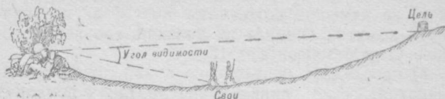
Рис. 90. Измерение угла видимости
